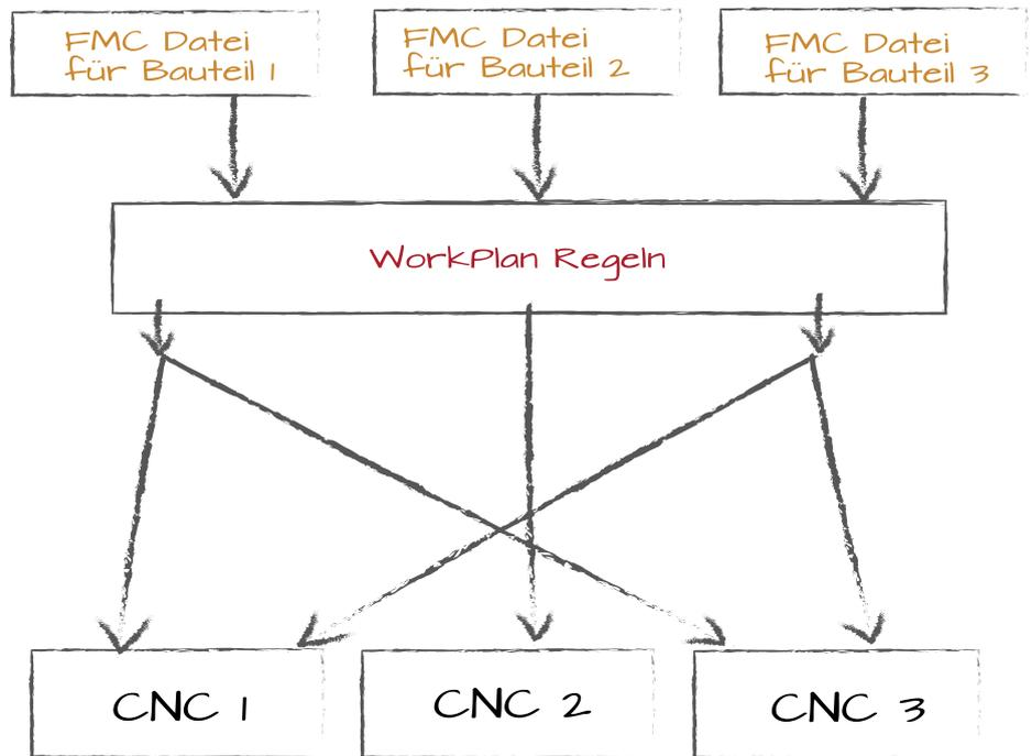
Die Regeln für die Werkzeugzuordnung und die Reihenfolge kann der Anwender in Menüs unabhängig von den einzelnen Konstruktionen einstellen. Vollautomatisch - d. h. ohne Mehraufwand - können so dieselben CAD-Daten auf den unterschiedlichsten CNC-Maschinen Ihres Maschinenparks laufen
